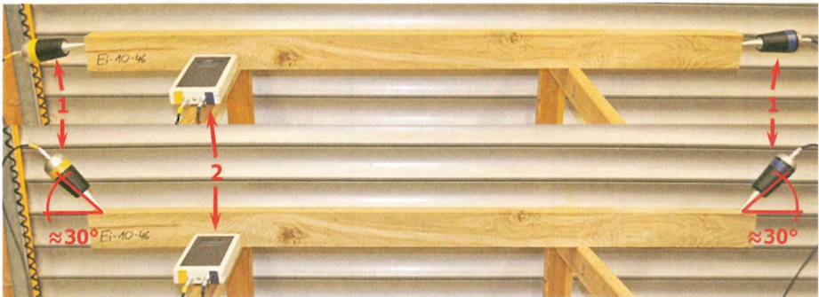
Bild 3. Durchführung der direkten (oben) und indirekten (unten) Ultraschall-Impulslaufzeitmessung (1 ... Sender-/Empfängersonde, 2 ... Messgerät) Fig. 3. Application of the direct (top) and indirect (bottom) ultrasonic time-of-flight measurement (1 ... emitting/receiving probe, 2 ... measuring device)
